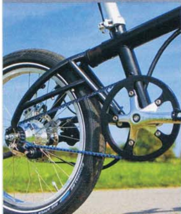
Erster Fahreindruck: Der neue Carbonriemen spart Kraft.
